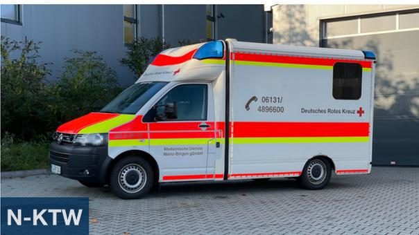
Die zwei Notfallkrankswagen verfügen über die meiste Ausstattung eines Rettungswagens gem. DIN EN 1789 Typ C, sind allerdings kompakter und für längere Fahrten mit Monitoring bestens geeignet. Sie verfügen über einen Tragestuhl, eine Fahrtrage Typ Stryker M1 mit Kinderrückhaltesystem, Sauerstoff (4.000 Ltr.), SpO2 Messung, EKG/Monitor/Defi Einheit, Notfallkoffer und Absaugpumpe. Ebenso sind eine Vakuummatratze und Schaufeltrage verfügbar.
