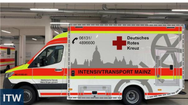
Für Intensivtransporte halten wir einen gem DIN 75076 vollumfänglich ausgestatteten Intensivtransportwagen vor. Dieser ist mit der Ausstattung eines RTW Typ C identisch und verfügt zusätzlich über ein Intensivbeatmungsgerät (Hamilton T1), zwei Absaugpumpen, bis zu acht Perfusoren, eine Intensivtransporteinheit (Stryker Powerload), Corpuls C3 Monitor/Defi Einheit, Schwerlasttrage und eine umfangreiche Ausstattung zur Behandlung von Intensivpatienten.
