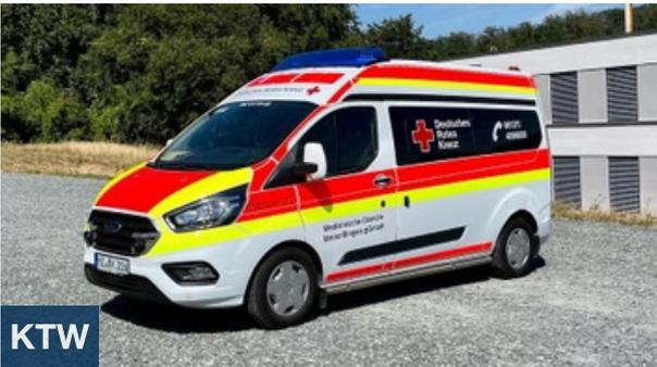
Unsere vier Krankentransportfahrzeuge sind alle gemäß DIN EN 1789 Typ A2 ausgestattet und verfügen somit über einen Tragestuhl, eine Fahrtrage Typ Stryker M1 mit Kinderrückhaltesystem, Sauerstoff (2.000 Ltr.), SpO2 Messung, Notfallkoffer und Absaugpumpe. Darüber hinaus führen wir eine Vakuummatratze und eine erweiterte Pflegeausstattung mit. Auch eine Schaufeltrage gehört zur Ausrüstung des Fahrzeugs, wie ein Defibrillator (AED) und mobiler Sauerstoff (400 Ltr.).
